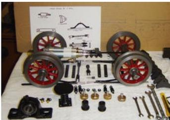
Im oberen Bild ist der Bauplatz zu sehen der selbst angefertigt wurde. Achsen mit den Speichenrädern. Die doppelten Brems-Zylinder und Hängeeisen so wie der Lagerbock.
