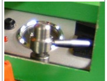
Bereitstellung. Dreht man nach rechts wird leicht gebremst und jede viertel Drehung gibt ein wenig mehr Bremsdruck. Nach einer Umdrehung ist der Druck von 2.5 Bar erreicht. Eine zweite Leitung wird als Speiseleitung der Wagenkessel beschrieben und dient um die Kessel der Wagen zu füllen, und auch wieder die Luft zur Lok zuleiten, wenn diese benötigt wird. Der Anschluss der Speiseleitung ist weiss gekennzeichnet.
